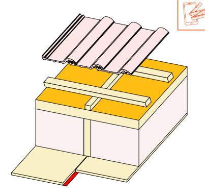
Holzwerkstoffplatte als luftdichte Ebene/
