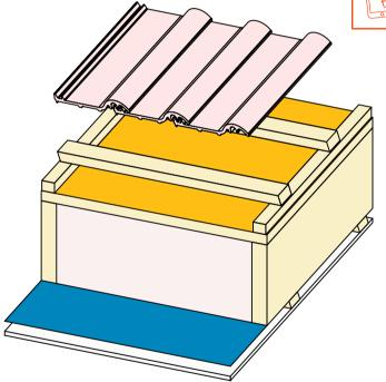
Holzrahmenbau Steildach Dachaufbau Var.1
