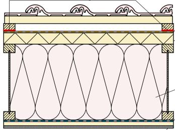
Innenbekleidung, auch mit gedämmter Installationseben
