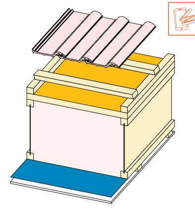
Holzrahmenbau Steildach Dachaufbau Var.3
