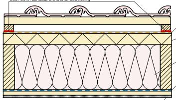
Innenbekleidung, auch mit gedämmter Installationseben/
