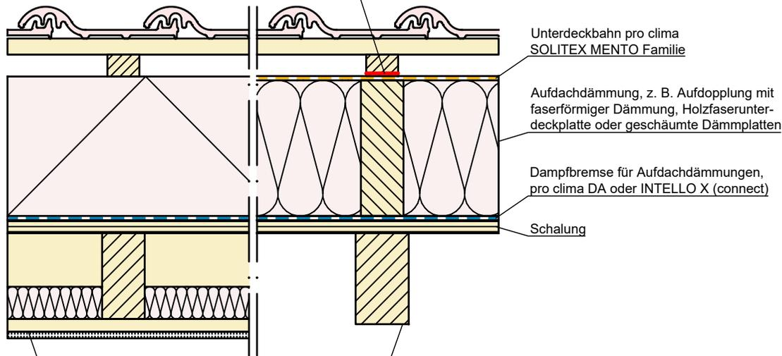
Sichtdachstuhl oder verkleideter Sparren, auch mit max. 20% der gesamt Wärmedämmung gedämmt. Bei höheren Dämmstoffdicken kontaktieren Sie die Technik-Hotline
