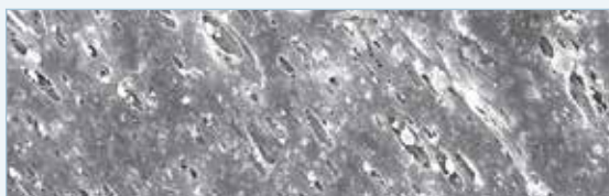
Abb. 19 Vergrößerung eines mikroporösen Funktionsfilmes
