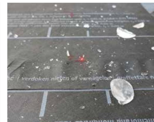
Die pro clima-Bahnen bleiben auch nach mehrfachem Beschuss mit den grösstmöglichen Hagelkörnern unbeschädigt
