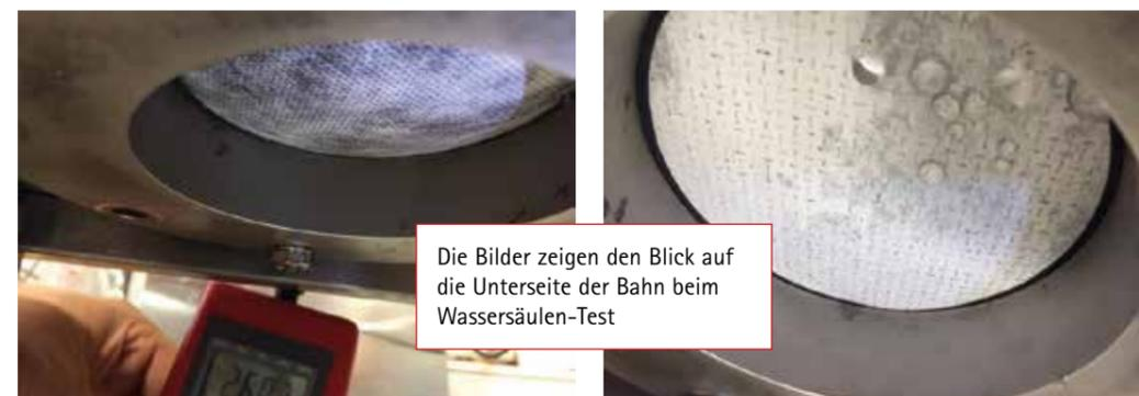
Die Bilder zeigen den Blick auf die Unterseite der Bahn beim Wassersäulen-Test
