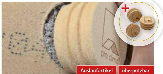
Verschlussstopfen für Einblaslöcher in Holzfaserplatten mit Dicken ab 35 mm. Passend für Bohrlöcher mit Durchmesser 106,5 oder 120 mm. CLOX unterliegen einem europäischen Patentschutz.
