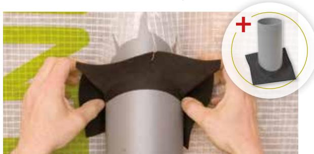
Für die schnelle und dauerhaft dichte Durchführung von Rohren durch die Luftdichtungsebene. Einsatz auch im Außenbereich, z. B. bei Unterdeckungen oder Sanierungs-Dampfbremsen. Verklebung mit TESCON VANA.
