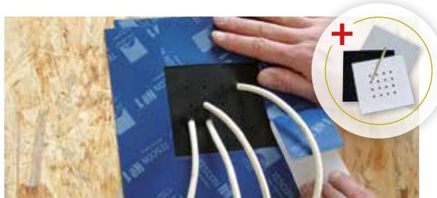
Für die schnelle und dauerhaft dichte Durchführung von bis zu 16 Kabel mit Durchmesser 4,8 bis 12 mm. Jede Manschette als komplettes Set inkl. Schablone und Stanzwerkzeug. Verklebung mit TESCON VANA.
